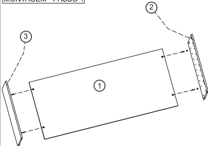
POSICIONE O FUNDO NO CHÃO E INICIE FIXANDO FUNDO (1), A LATERAL DIREITA (2) E A LATERAL ESQUERDA (3).
